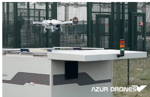
👉 Obrázek 14: Autonomní dron Skeyetech monitorující přístav, kde je omezen pohyb osob
